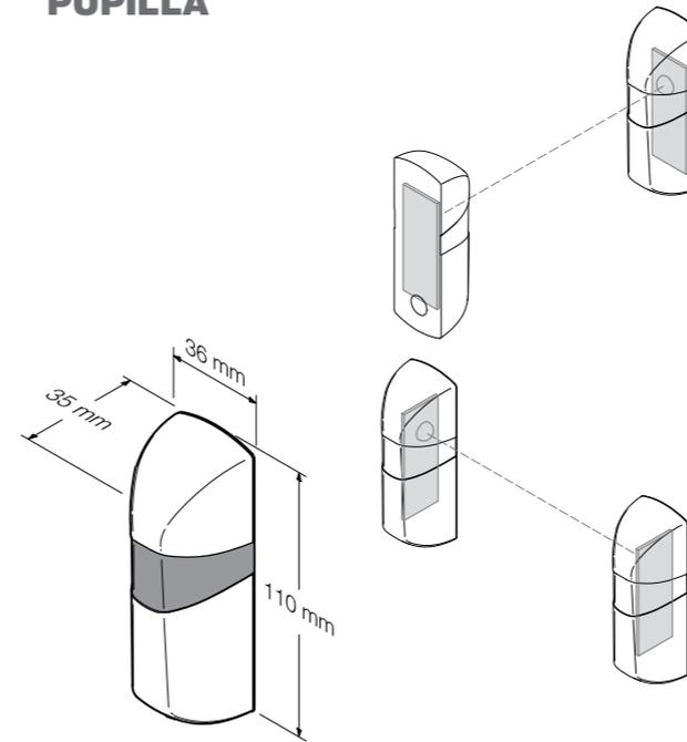
La rotation à 180° permet l'alignement des photocellules indépendamment du mode de fixation de la base
