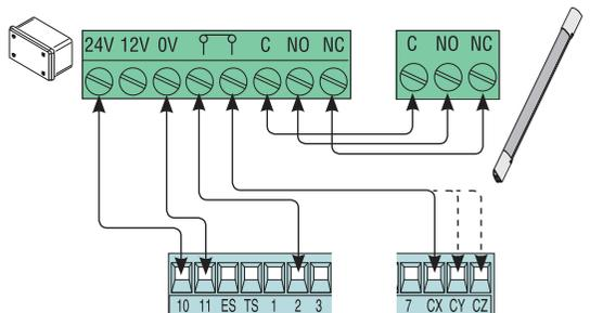
Connexion bords sensibles (contact NF) - Voir menu [FONCTIONS] → [entrée CX], [entrée CY] ou [entrée CZ] pour associer un mode de fonctionnement à chaque entrée.
