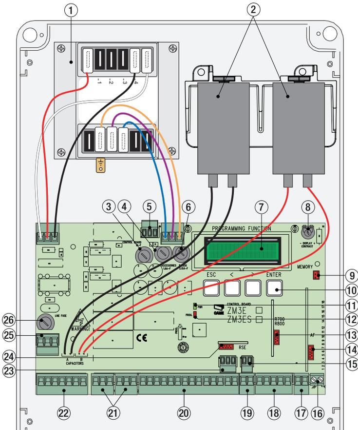
\* ② Inclus dans l'emballage des motoréducteurs FROG 230 V. Les connecter aux câbles noirs (moteur M1) et rouges (moteur M2), prévus dans la carte ; en présence des motoréducteurs Ati, Fast, Fermi et Krono, ces câbles ne sont pas utilisés (les condensateurs sont connectés à l'intérieur).
