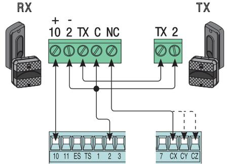
Connexion photocellules (contact NF) - Voir menu [FONCTIONS] → [entrée CX], [entrée CY] ou [entrée CZ] pour associer un mode de fonctionnement à chaque entrée.
