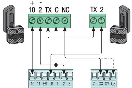
Connexion photocellules pour **Fonction test de sécurité** - Voir menu [FONCTIONS] → [Test Sécurité] pour activer la fonction et choisir les photocellules qui devront l'effectuer.
